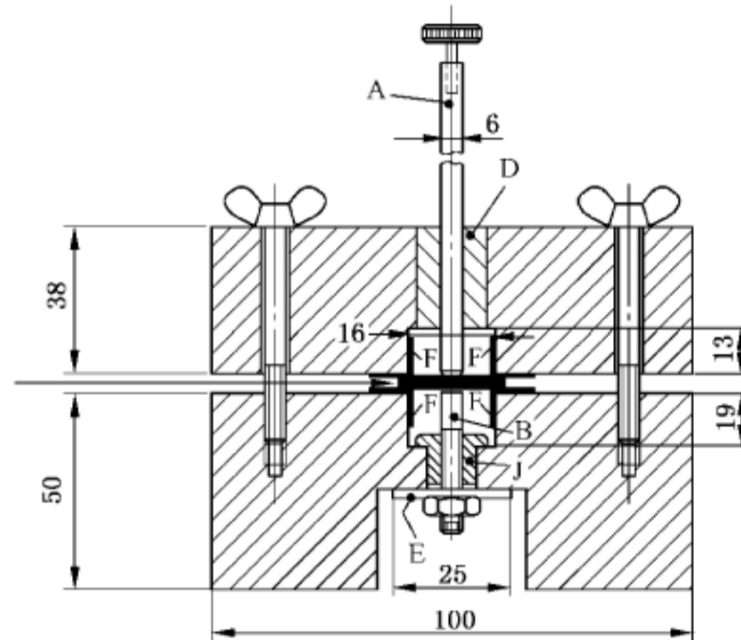
b) 上电极微微提起的装置剖面图
