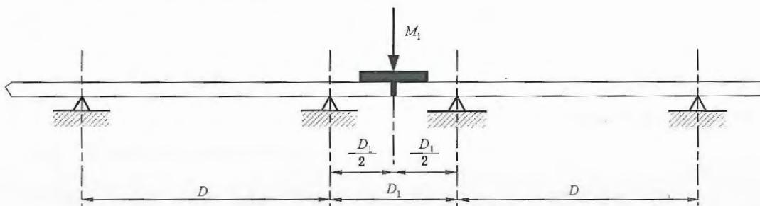
图 102 连接点的机械负载试验
