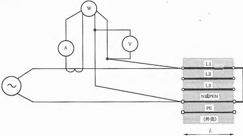
图 DD.1 故障回路电阻和电抗确定
