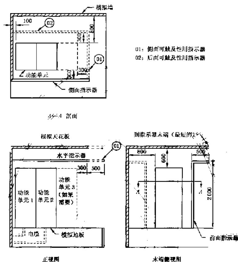
图 A.4 A 级可触及性的试验室模拟和指示器位置, 功能单元高度在 1.5 m 及以上
