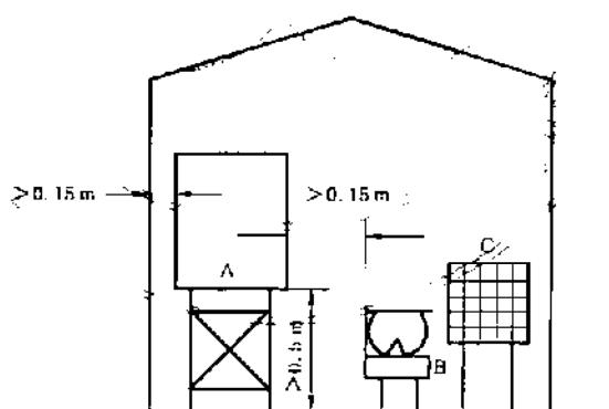
A——试品；B——喷雾装置；C——加热装置。
