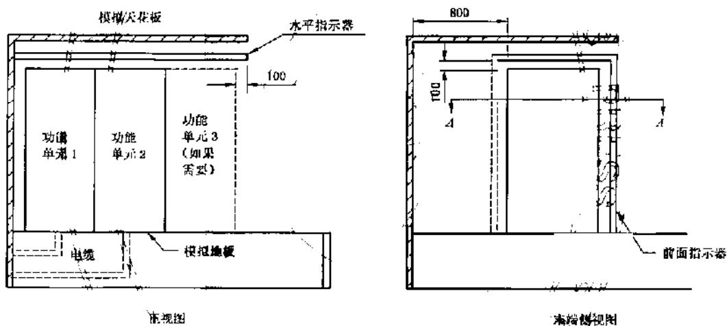
图 A.6 B 类可触及性的试验室模拟和指示器位置/功能单元在 2 m 以下
