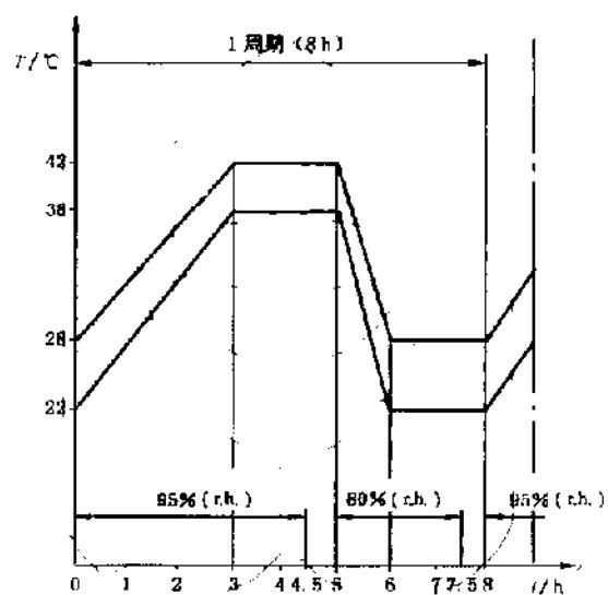
图 C. 3 穿透性试验 参考性测量(设备带电) (4 h)-相对湿度
