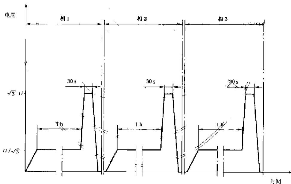
图 C.7 按程序 A 或 B 后的工频湿耐压实验
